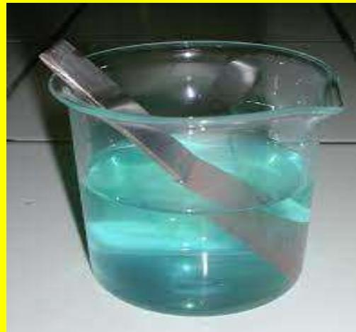
l'ion cuivre (II) Cu<sup>2+</sup> est un oxydant car il est capable de donner du cuivre en captant deux électrons selon la réaction.
