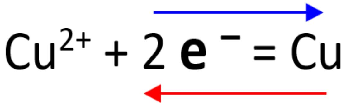
Sens 2 : Oxydation de Cu en Cu<sup>2+</sup>
