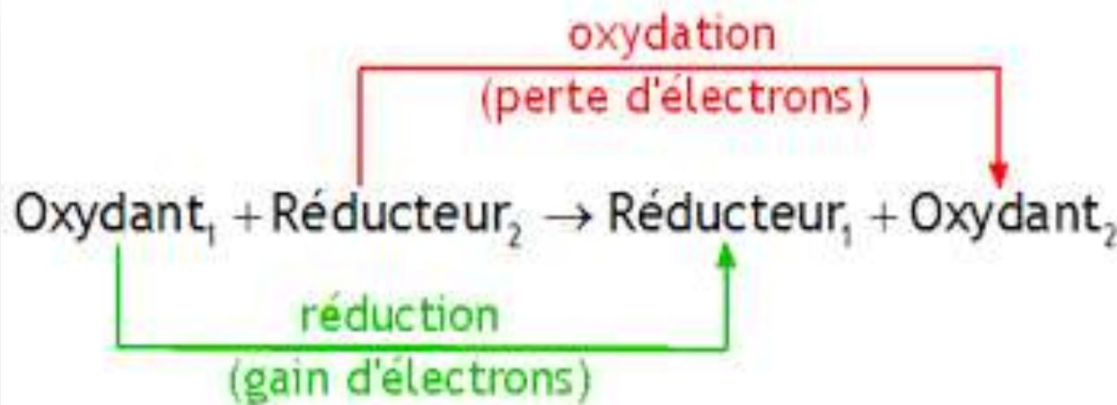
Une réaction d'oxydoréduction est une réaction chimique au cours de laquelle se produit un échange d'électrons. L'espèce chimique qui capte les électrons est appelée « oxydant » ; celle qui les cède, « réducteur ».
